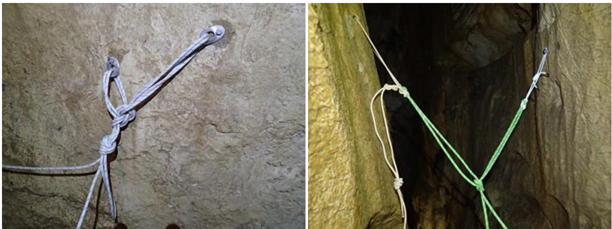
Amarrages sans mousquetons, nœud de chaise double en double tressé dans les plaquettes en milieu de corde, dyneema dans une lunule et AS avec nœud plat et tisserand pour un Y. Photos CD.
