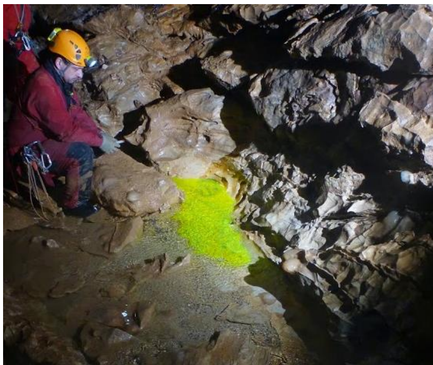
Figure 10 : Apparition de la fluorescéine lors du traçage
