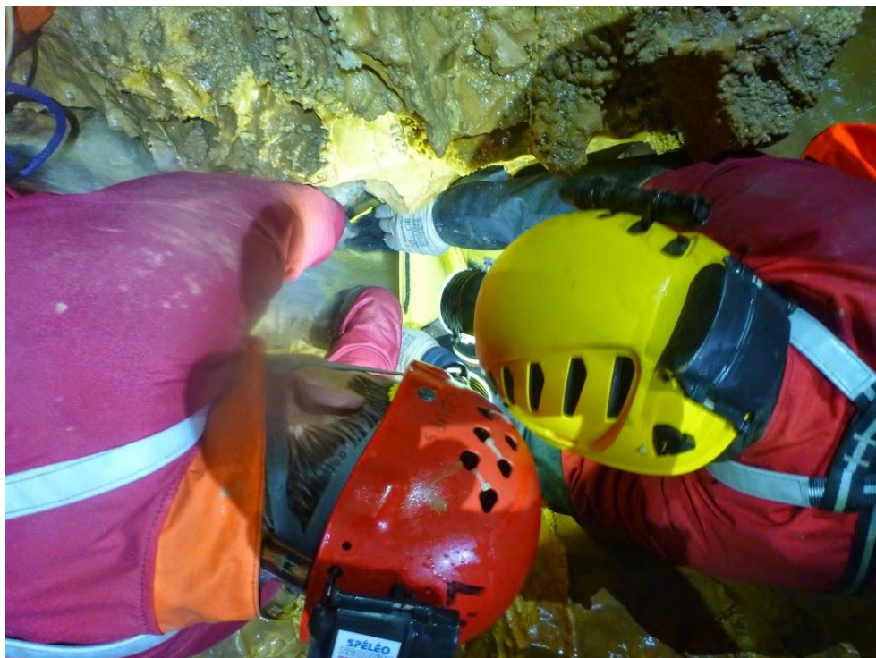
Figure 11 : Remplissage d'un kit dans le petit actif du réseau Nord pour mesure de débit
