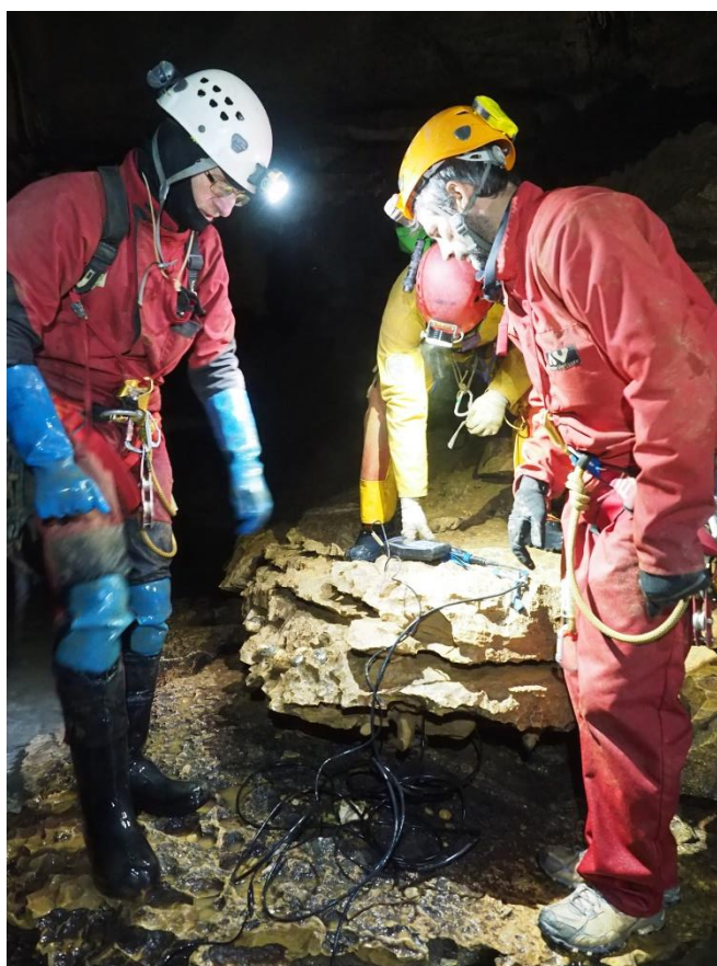
Figure 17 : mesure débit au sel et à la fluorescéine, rivière des gours
