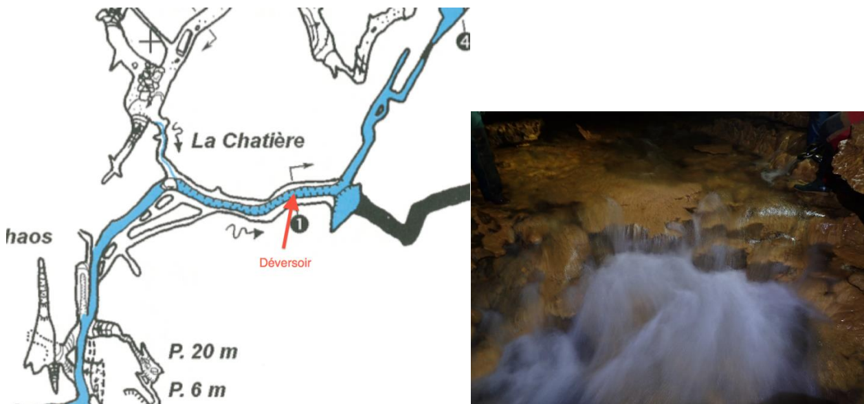
Figure 47 : localisation et photographie du déversoir utilisé pour la méthode hydraulique, rivière à la base des puits (équipe 3)
