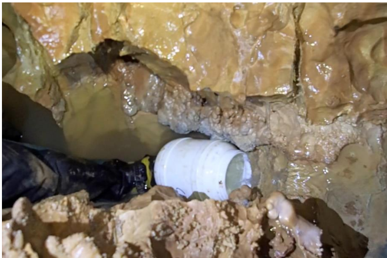
Figure 44 : mesure de débit capacitive, réseau Nord (équipe 3)
