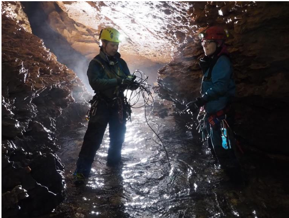
Figure 1 : préparation de la mesure de débit au sel et fluorescéine, rivière Ben
