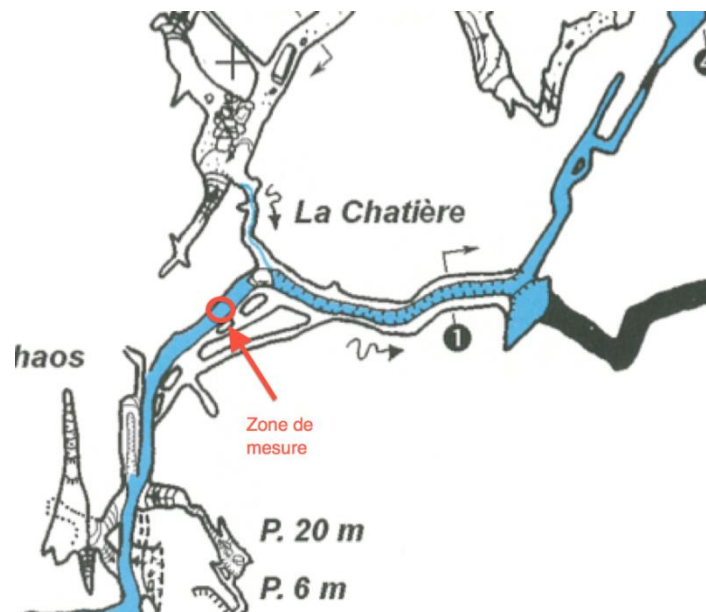
Figure 48 : localisation de la station de mesure aux flotteurs, rivière à la base des puits (équipe 3)
