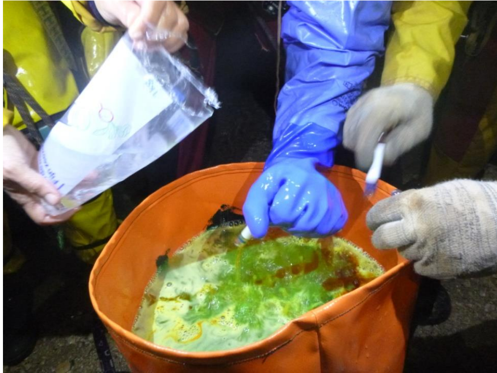
Figure 33 : préparation de la solution de sel et de fluorescéine, rivière des gours (équipe 2)
