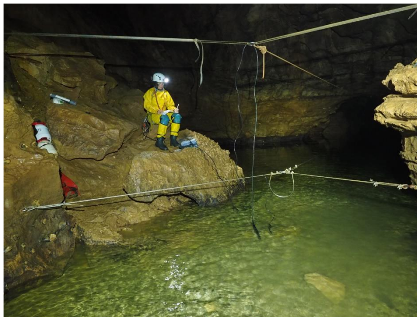
Figure 38 : collecte des mesures lors des jaugeages au sel et à la fluorescéine, rivière des gouts, au pont de singe
