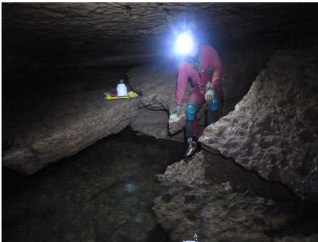
Figure 31 : mesure de conductivité lors du jaugeage au sel, rivière au départ de la chatière (équipe 2)
