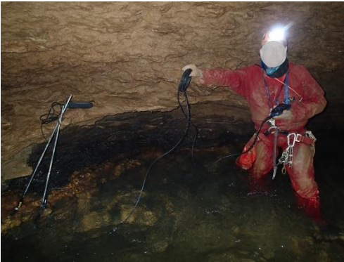
Figure 4 : réalisation des mesures de conductivité et de concentration en fluorescéine
