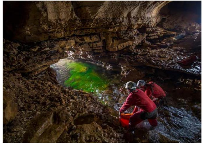
Mesure de débit à la fluorescéine à l'amont de la base des puits
