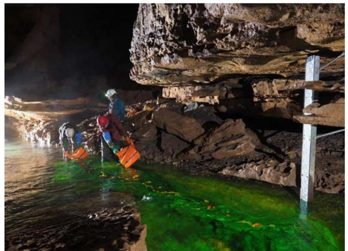
Injection de fluorescéine à la base des puits
