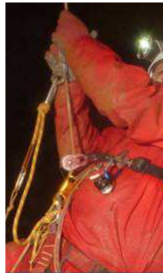
Figure 1 : montage avec poulie fixe Petzl
