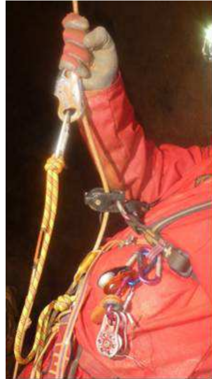
Figure 4 : montage avec la poulie ouvrante
