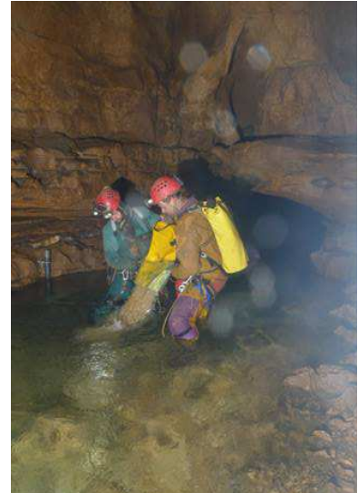
Préparation de la solution salée, déversement du sel et mesure de la conductivité
