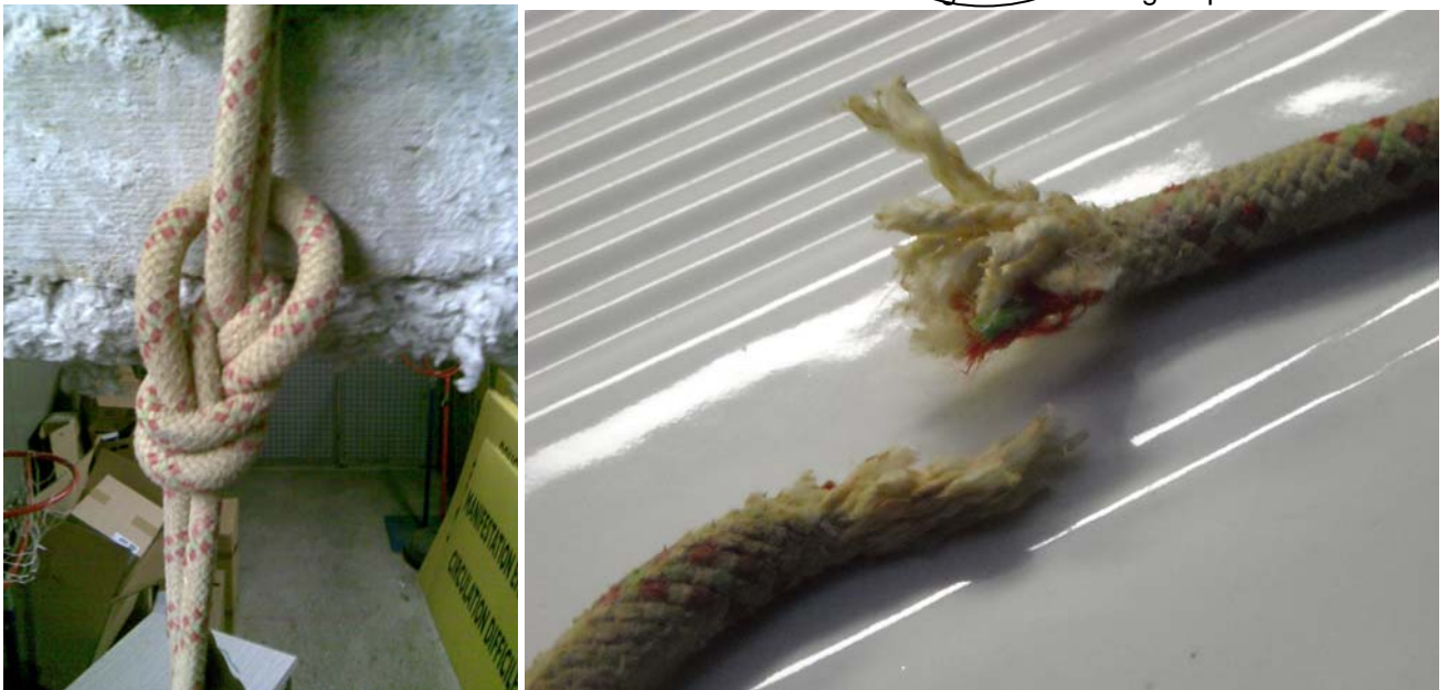
Rupture au 6 e choc dans le nœud
