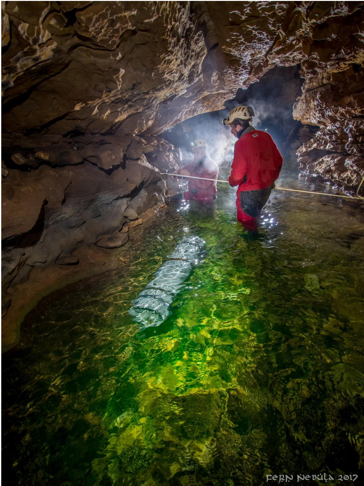
On peut distinguer le tube de Pitot au premier plan tandis que les spéléologues mesurent les dimensions de la section de galerie pour une autre expérience. En même temps, l'injection de la fluorescéine a été effectuée.
