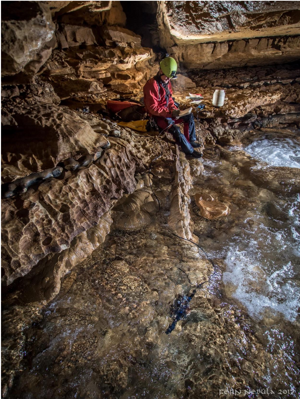
La station de relevé en aval de l'injection de la fluorescéine. On peut distinguer la sonde au premier plan tandis que le spéléologue prend note sur son cahier les résultats obtenus à intervalles réguliers.
