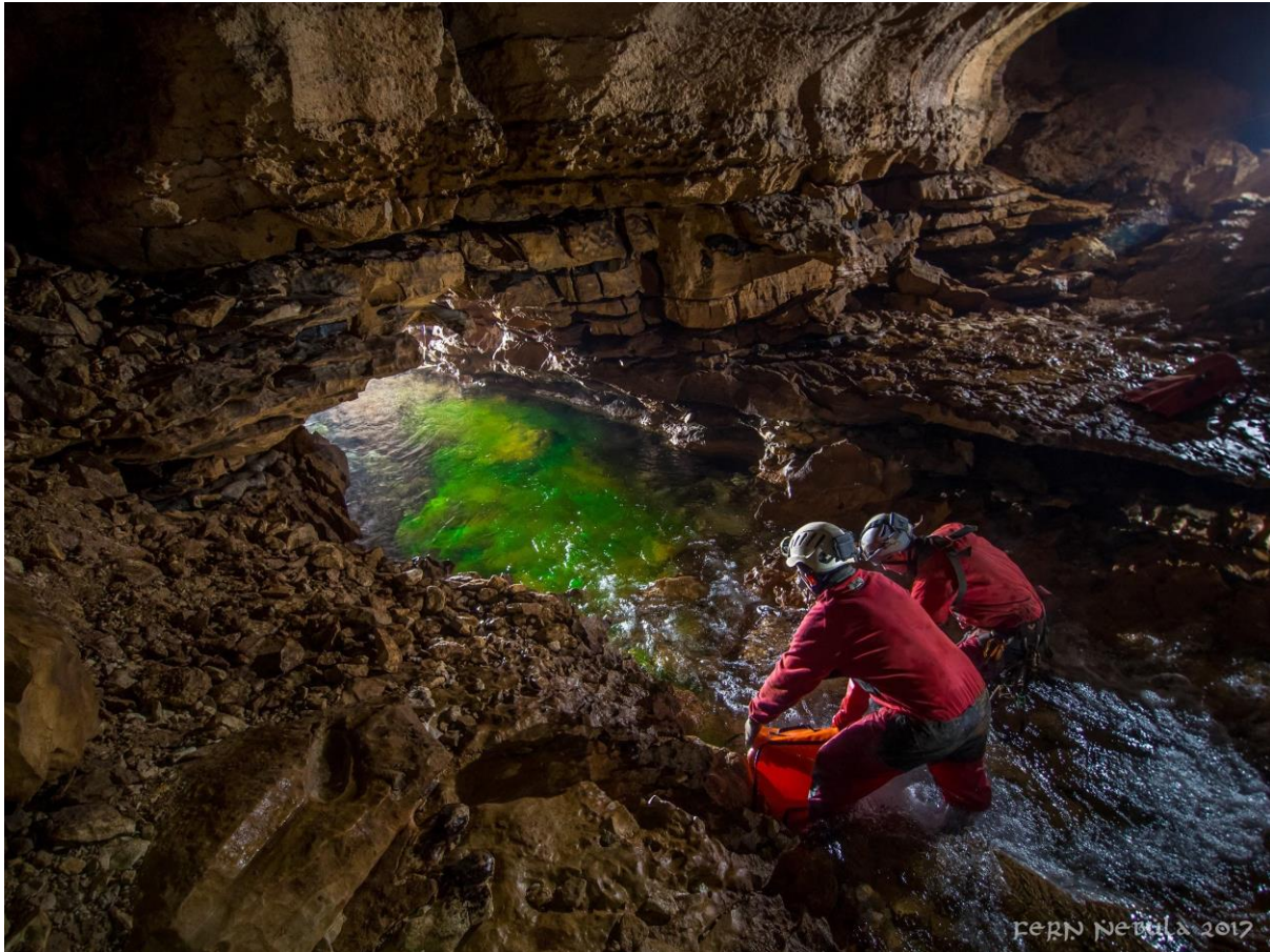
Injection de la fluorescéine dans la rivière (zone de la base des puits du gouffre de la Combe aux Prêtres).
